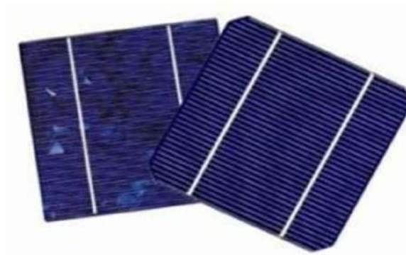
Figure 4 : Cellules en silicium polycristallin (gauche) et monocristallin (droite)
