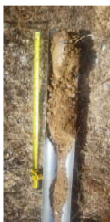
Carottage dans la zone la plus profonde du sol le 03/09/2025 ; seuls les 20 premiers cm comportent des traces minimales d'oxydation.
