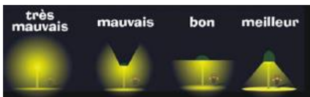
Figure 61 : Systèmes d'éclairage public
